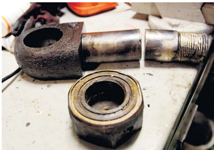
SYNDEREN: Dette er årsaken til maskinhavariet. Staget i bakgrunnen er bøyd, og førte til full stopp i pumpen som frakter eksos ut fra maskinrommet. FOTO: CHRISTIAN E. BERGHEIM
